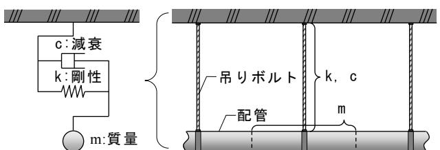
図 5 一質点系モデルの概要
