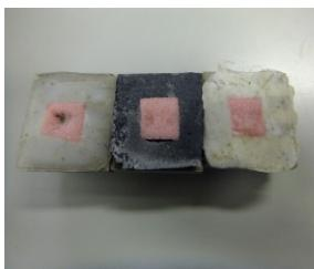
写真 4 空隙試験体
