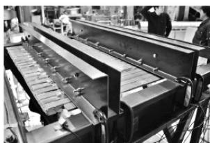
写真 2 実構造部材の取付け状況
