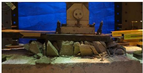
図 21 厚さ 100mm モルタルの崩壊（鉛直荷重あり）
