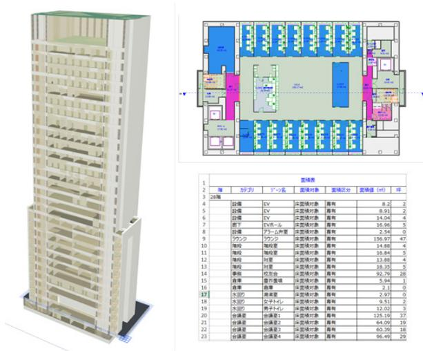
図 3 作成した BIM モデルの例<sup>2)</sup>
