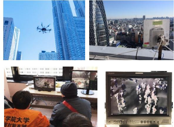
図 4 実験の様子（左上：新宿中央公園上空で飛行するドローン、右上：工学院大学屋上の FWA 無線アンテナ、左下：西口現地本部でのドローンからの映像受信、右下：西口現地本部で受信したサーモグラフィー映像）
