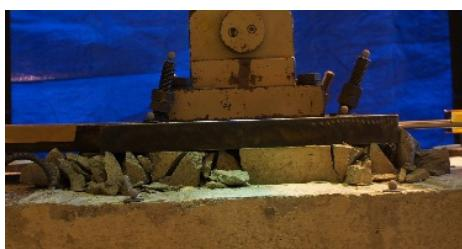
図 20 厚さ 50mm 最大耐力時の状態（鉛直荷重あり）
