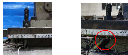
(f) アンカーボルトの傾き (g) アンカーボルト破断 図 15 試験体の様子
