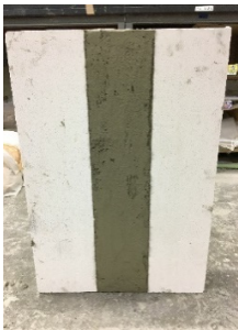
c) A タイプ壁面補強試験体
