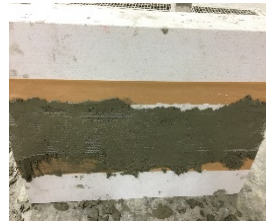
b) PP シート被着時の試験体
