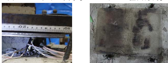
(d) アンカーボルト破断 (e) モルタル表面[実験後]
