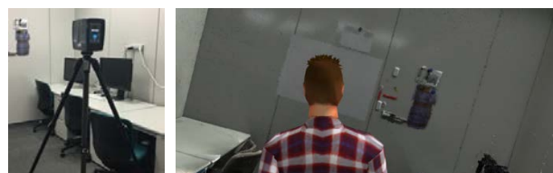
図 3. 室内 3D 計測の様子（左）と作成した VR 空間を傾斜させた様子（右）被験者は右図に写る人物目線の映像を HMD にて観察した（室内傾斜 15 度の条件）
