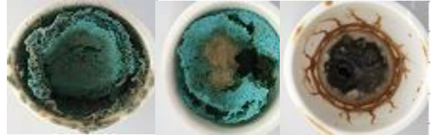
a) 標準サイディング \text{Na}_2\text{CO}_3 70% b) 木チップ \text{Na}_2\text{CO}_3 70% c) 木チップ \text{Na}_2\text{CO}_3 30%
