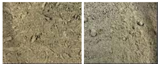
(a) サイディングF (b) 振動ミル 写真2 振動ミル (2次破碎)
