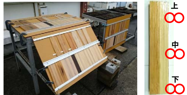
図2 曝露試験体の様子と測定箇所
