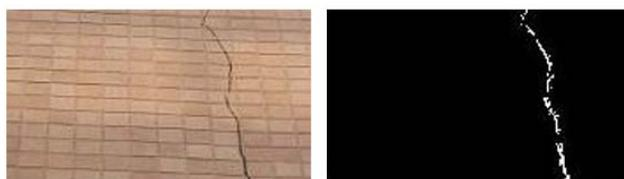
図7 ビル壁面画像（左）と自動検出した傷領域（右）
