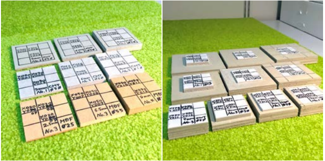
a) 一層試験体 b) 二層試験体 写真4 試験体（研究3）
