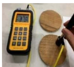
a)衝撃弾性波硬度試験
