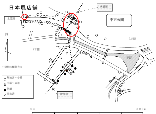
図6 豊原市中正公園近傍の断層と建物被害（矢印は建物傾斜の向き 3) ）。右写真の1階に壁のない非常に古い日本風店舗は無被害
