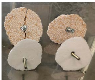
d)荷重によるビス引抜状況
