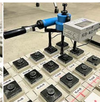
写真3 引張破断試験
