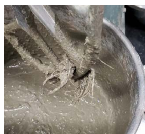
b) EFB ファイバー混入モルタルのフレッシュ状態
