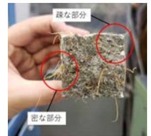
b) 試験体の割裂断面
