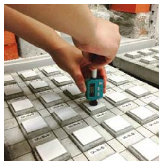
写真2 弾性波速度比測定
