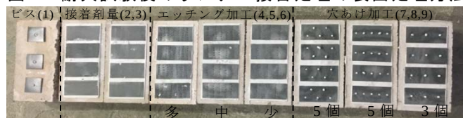
図 5 耐火試験後のランナー接合処理の表面処理方法
