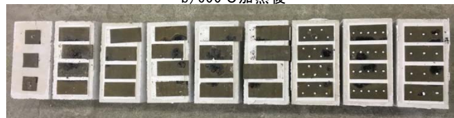
図 6 耐火試験後のランナー接合面の性状(研究 3)
