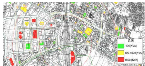
Fig.16 非常用発電機(消防法の法定外)の設置状況
