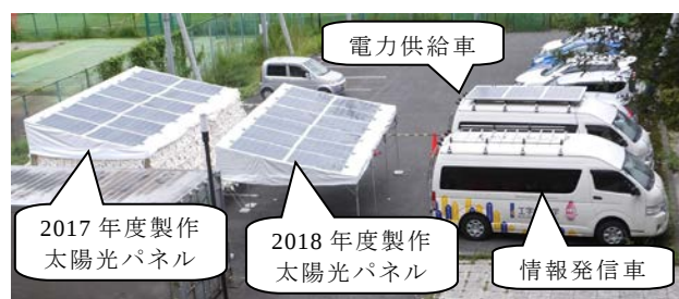
図 10 D-ZEV 組合せ試験の状況
