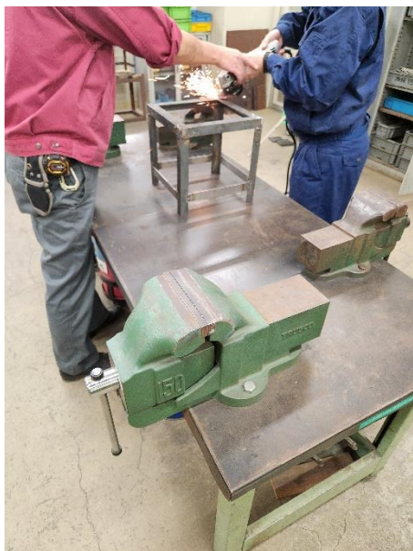
図 4 溶接後の研磨作業
