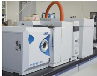
GC/MS：例えば食品中のおい成分の分析など、食品、香料、材料中の複数の揮発性化合物を分離・検出し、分子構造を解析できる。
