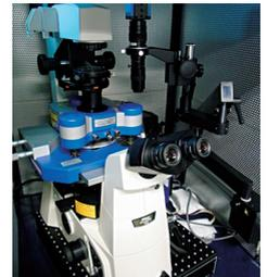
原子間力顕微鏡：物体の凹凸を0.1ナノメートル単位で計測が可能。
