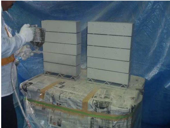
写真 5-1 吹付けによる仕上材の施工風景
