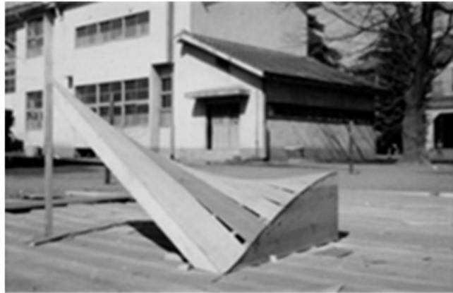
写真 2-16 切断 HP シェルの模型
