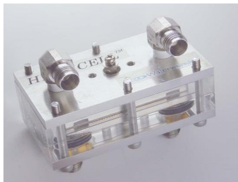
メッシュ型電極を内蔵した小型水電解セル
