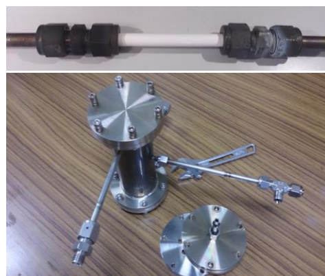
(上)水素分離シリカ膜, (下)水素分離シリカ膜モジュール
