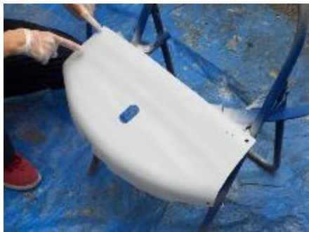
Fig.2 サフ吹きの様子
