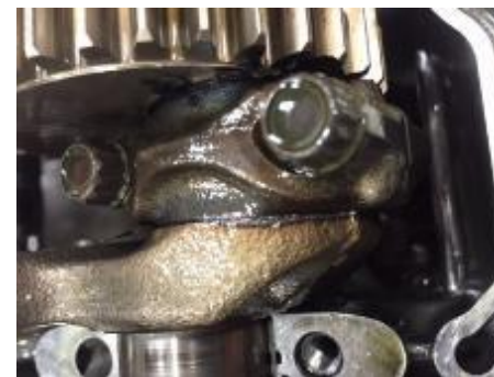
Fig.4 焼き付いたクランクシャフトとコンロッド (#4)
