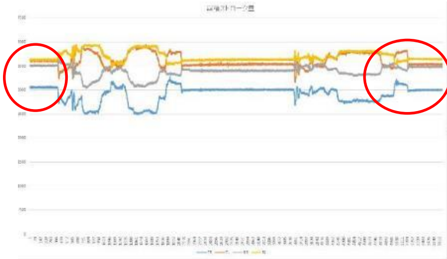
Fig.8 ストロークセンサーの始点と終点の誤差
