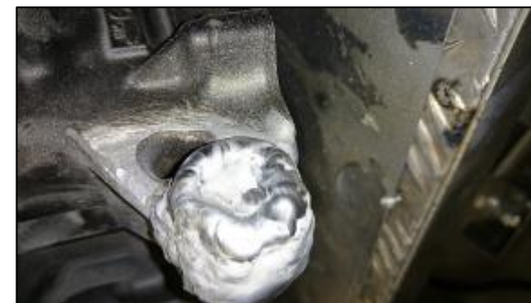
Fig.5 フロントエンジンマウント肉盛り
