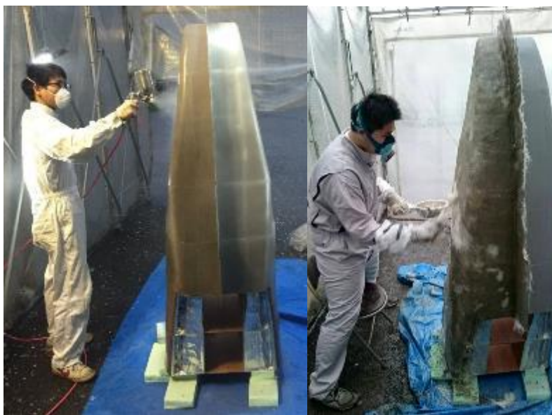
Fig.1 カウル製作の様子
