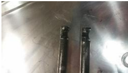
Fig.11 左、旧エンジンのリフトレバー、右、摩耗したリフトレバー
