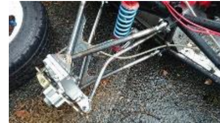
Fig.2 折れ曲がったタイロッドとタイロッドブラケット
