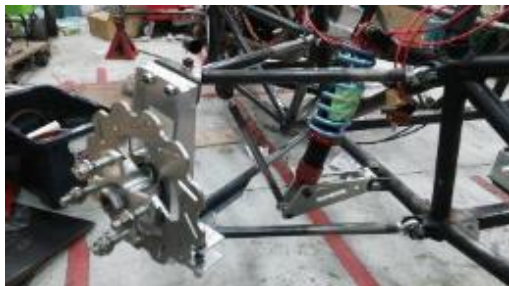
Fig.5 完成した A アームとフロントハブ
