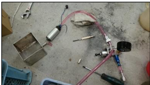
Fig.13 純正フューエルポンプインライン化動作実験
