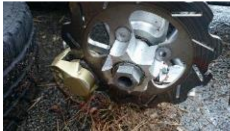
Fig.1 破損したフロントハブ
