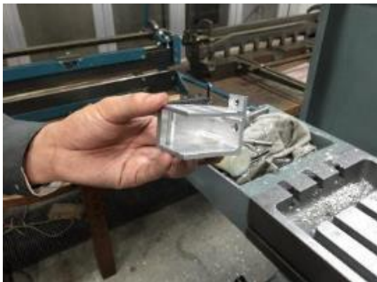
Fig.4 完成したタイロッドブラケット
