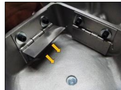
Fig.13 導入検討中のワンウェイバルブ
