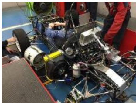
Fig.6 シャシダイ用 Intake での計測
