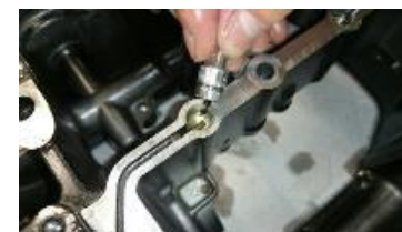
Fig.9 ガスケットが詰まっていた流路
