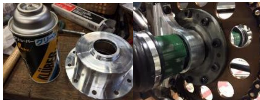
Fig.2 O リング組み付け
