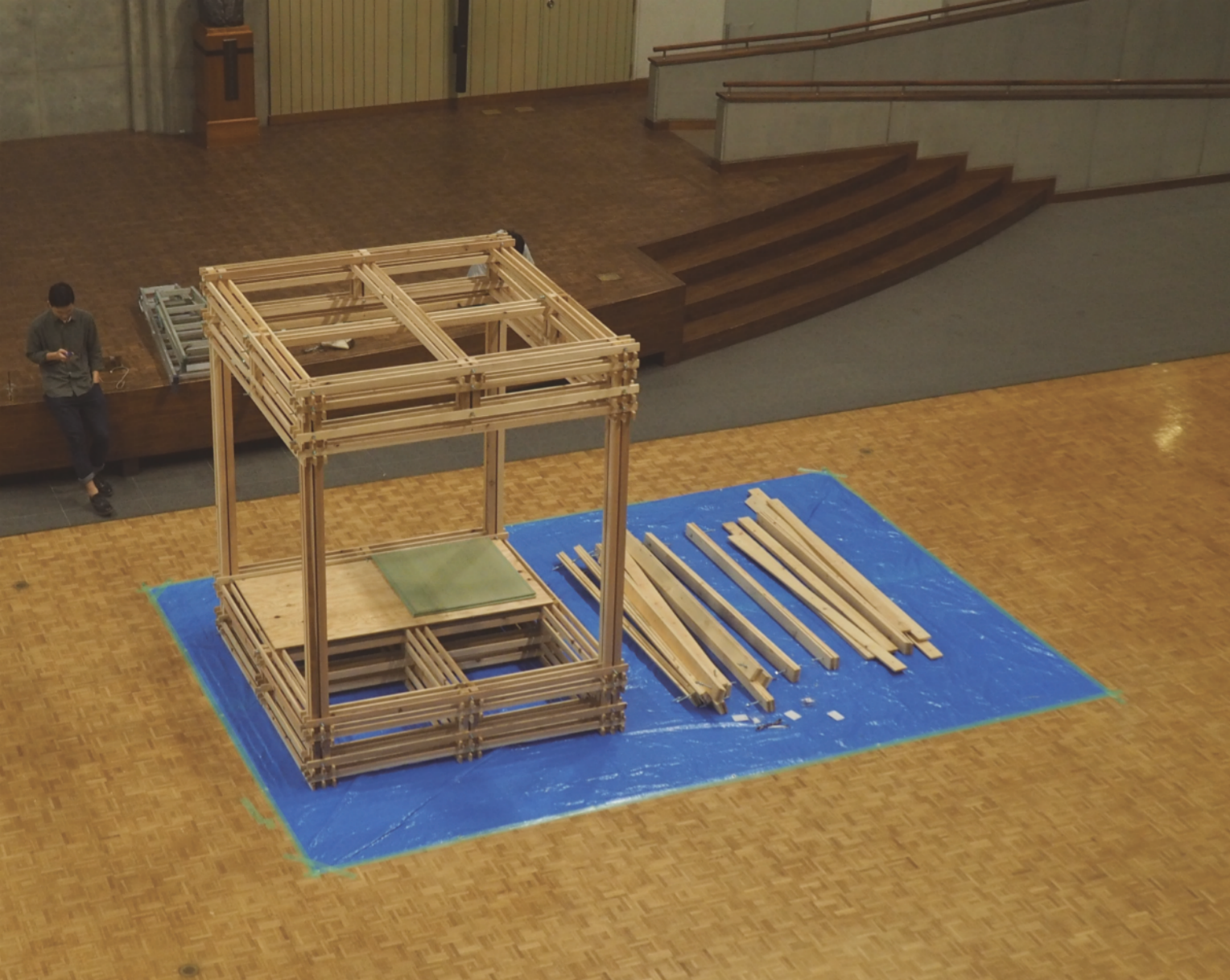
その1 構造部となる横架材を3枚で1セットとし、井桁状に組み。 部材一本は軽く、ボルトがガイドとなり容易に組み立て出来る。
