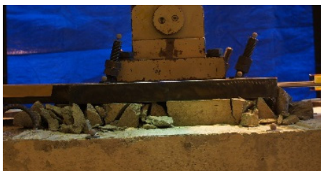
図 20 厚さ 50mm 最大耐力時の状態（鉛直荷重あり）
