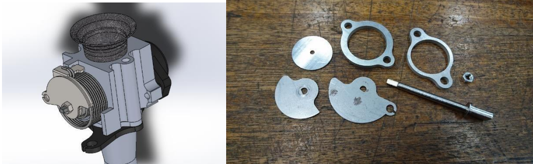
Fig. (左)設計変更を行ったスロットルボディ(右)製作したパーツ
