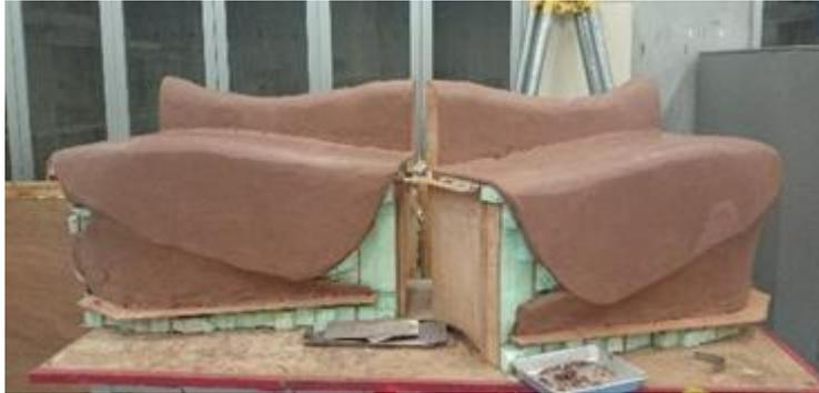
Fig4. クレイによるサイドポンツーンの雄型
