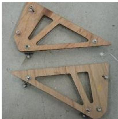
Fig5. アンダーパネルリア側ステイ試作
