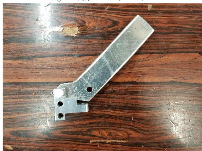
Fig.6 試作クラッチペダル
