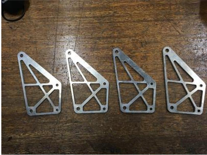
Fig.7 ワイヤ放電で製作したフロントベルクランク
