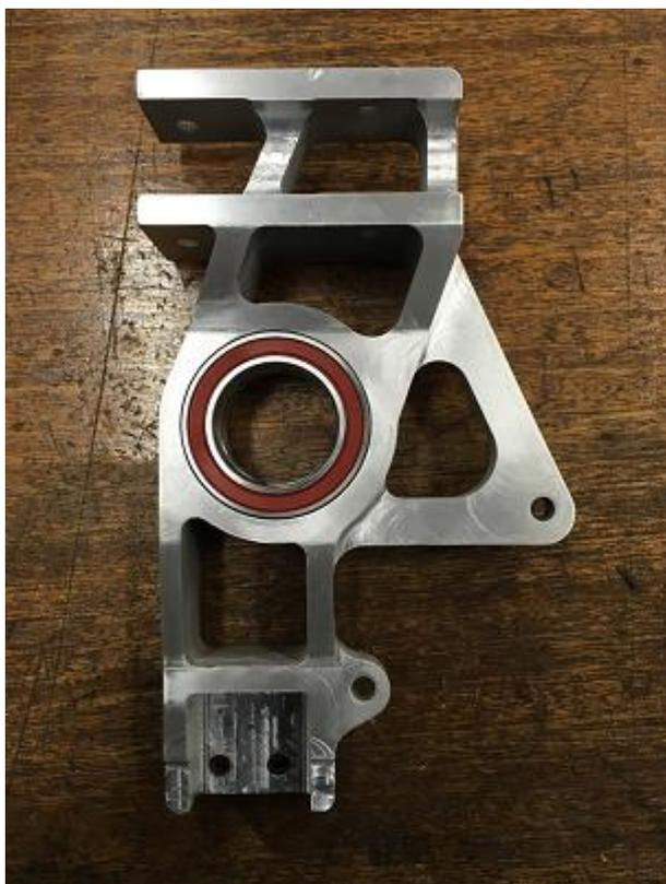
Fig.6 再製作したリアアップライト
