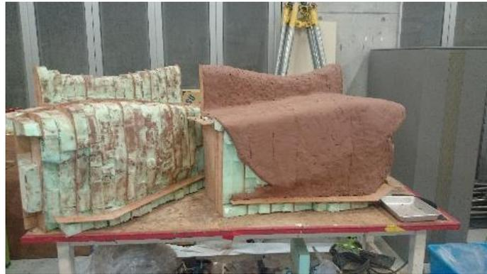
Fig. サイドポンツーン粘土型
