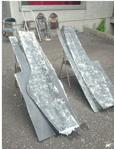
Fig8. 修正作業中のアンダーパネル
