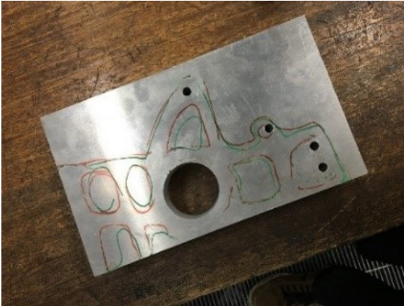
Fig2. 軸穴加工途中のリアアップライト
