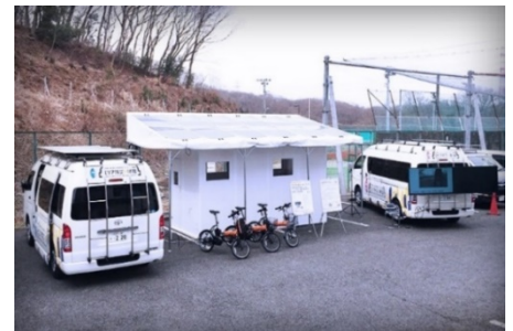
「D-ZEV」 災害時に情報通信、救急救護などを行うためのエネルギー供給設備を含めた各種装置を搭載
