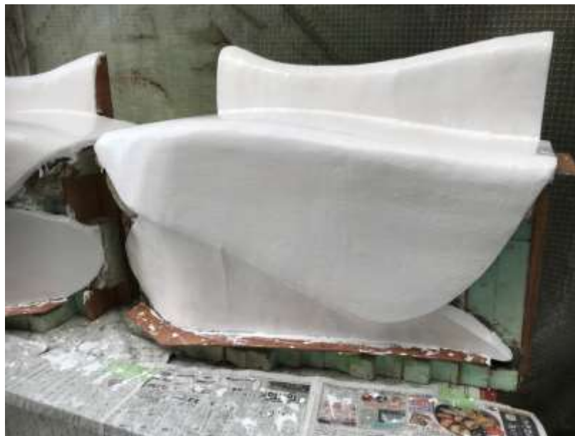
図5 PVA、ゲルコート （Gelcoat） を塗り終えたサイドポンツーン
