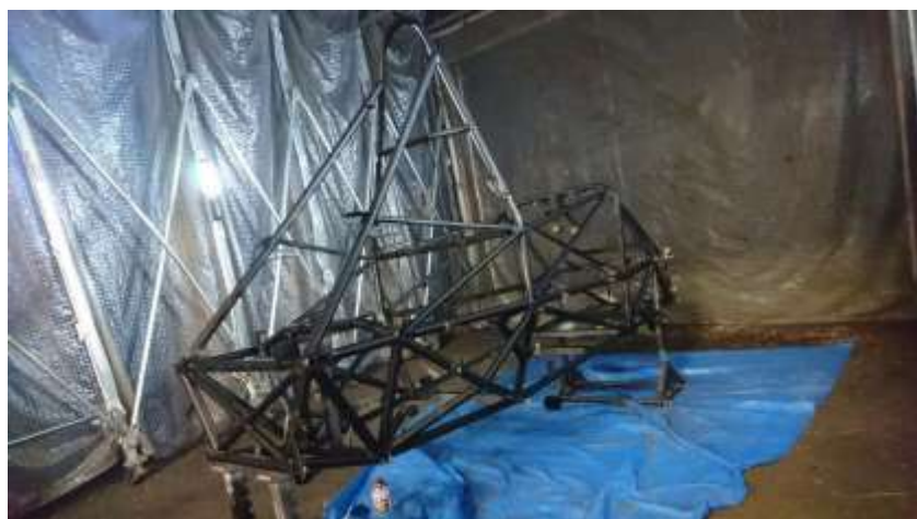
図 10 塗装済みフレーム
