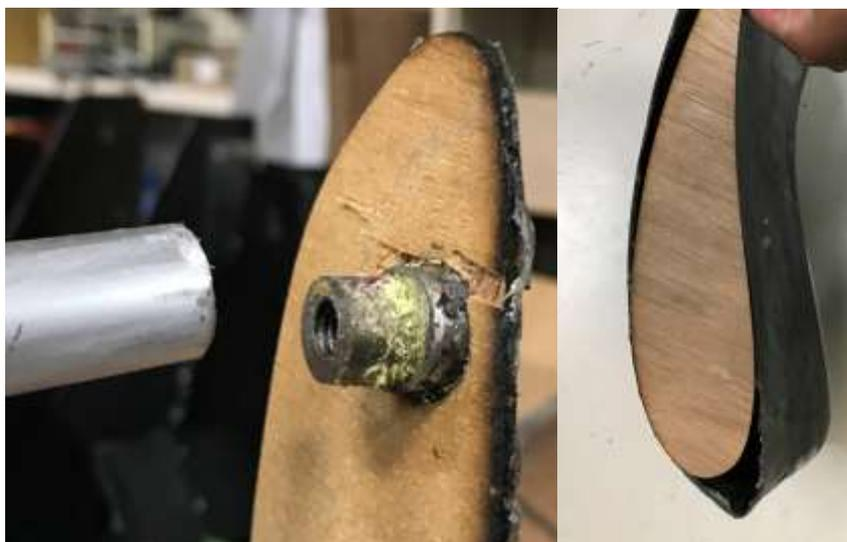
図3 左:リブ破損部分 右:木型と翼形
