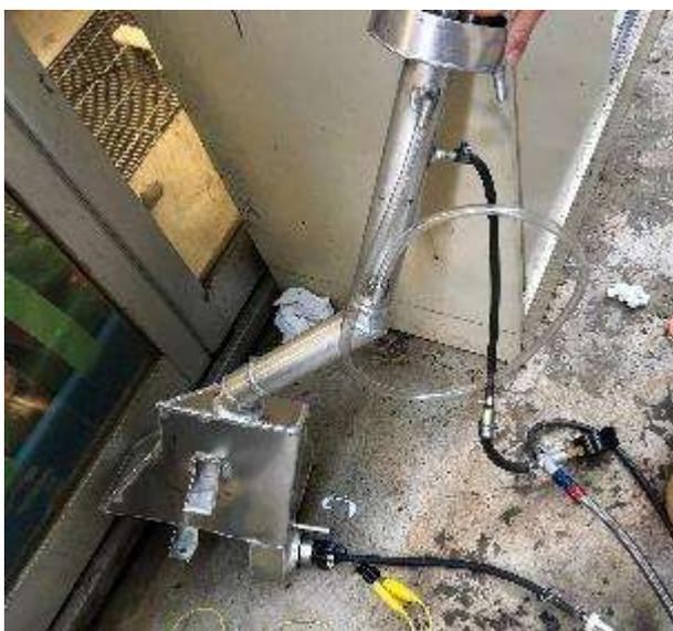
図1 製作した燃料タンク
