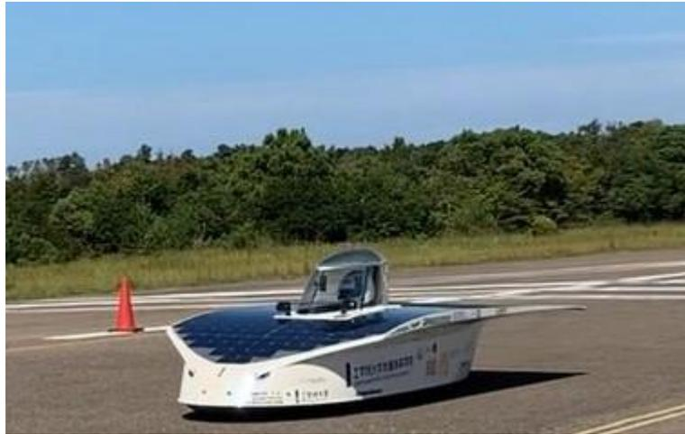
レース初日は台風16号の影響による激しい雨と強い風に見舞われ、全チームが走行できないまま2日目の本戦を迎えました。工学院大学附属高校自動車部は、加減速の回数が多いコースの特徴を考慮して、モーターの負担を軽減するモーター冷却装置と温度モニタを備えて参加しました。計器や戦略システムは、IT化、情報工学のネットワーク技術を導入して製作したことにより、効率が良い状態で安定した走り続けることができました。大会運営の都合で、走行時間が急遽1時間短縮されたものの、一周2540mのコースを5時間で104周し、最上位クラスのエキスパートクラス3位、別クラスを含めた総合3位でゴールしました。
