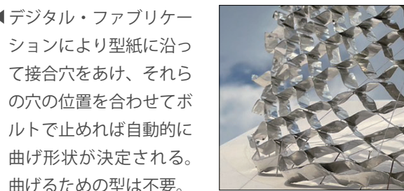
⑦デジタル・ファブリケーションにより型紙に沿って接合穴をあけ、それらの穴の位置を合わせてボルトで止めれば自動的に曲げ形状が決定される。曲げるための型は不要。
