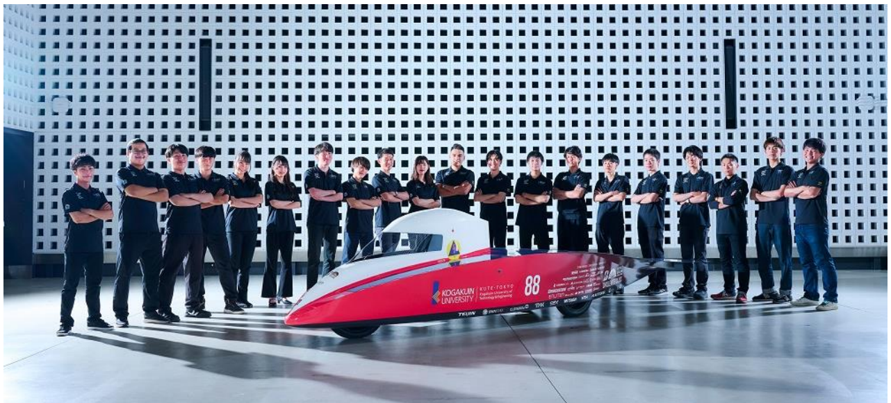
世界大会に挑む新型ソーラーカーとチームメンバー。前輪1輪、後輪2輪、計3輪の単胴型を採用。
