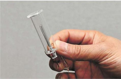
ガラス管内の希ガスに電圧をかけて紫外線を発生させる
