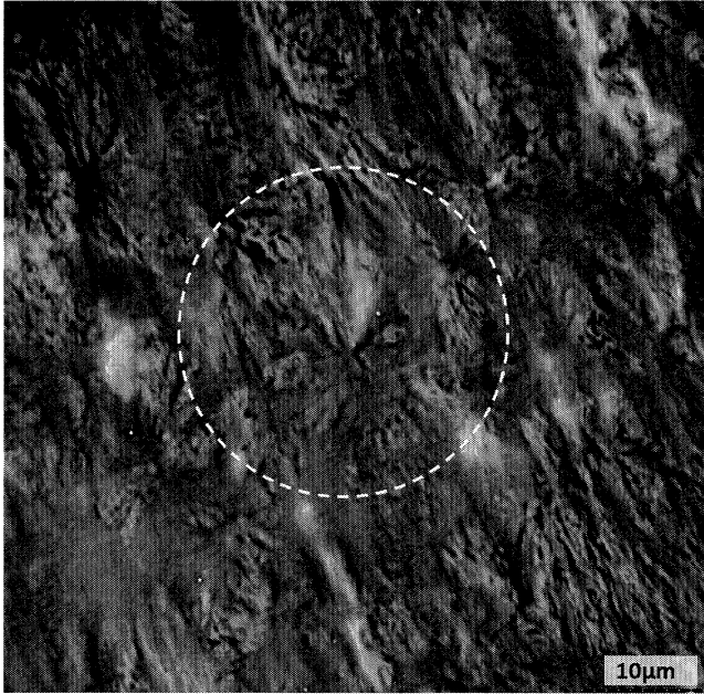
図5 生分解性プラスチック PLA 熱処理後の切片の TEM 像、破線で示した領域が球晶成長部分と思われる。
