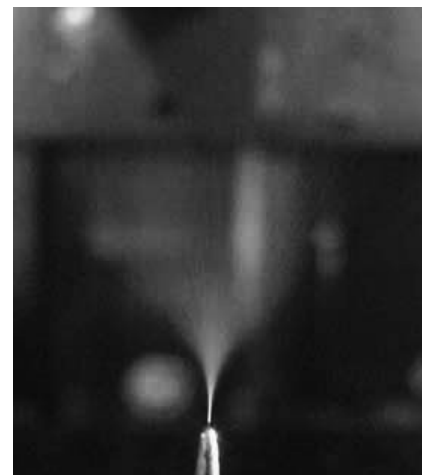
ニードルの先端より噴霧されるP3HT溶液の様子
