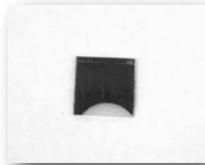
TiO 2 /Ti/C(イオンビーム照射層)/PGA -80°C冷却、
