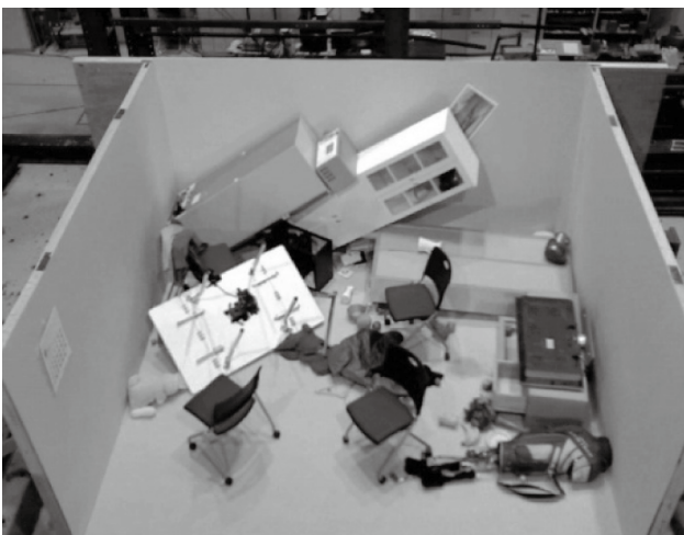
図1 大変位振動台による超高層ビル高層階の室内被害実験
