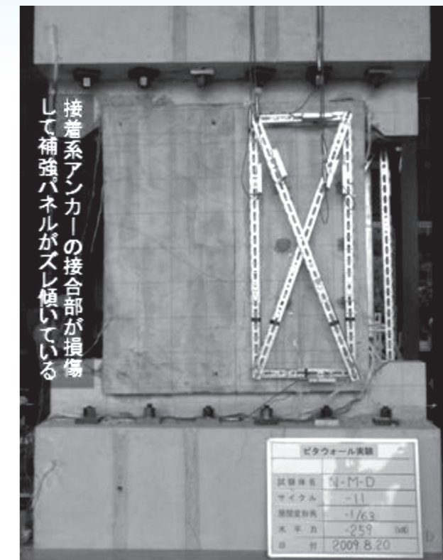
写真1: RC集合住宅を対象とした補強パネルの耐震実験の実施
