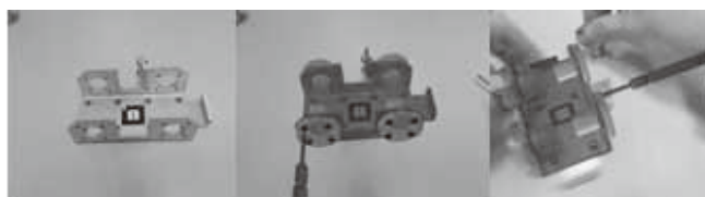
図 2 AR により提示される作業支援手順
