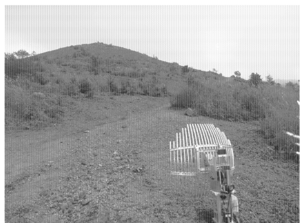
Fig.26 自動追尾アンテナシステムの実証実験の様子
