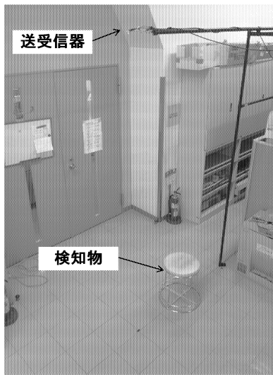
図 12 部屋を用いた実験系(疑似センサノードから信号を送信し、受信信号を再び送り返す)
