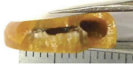
Fig. 1 空隙の生じた結晶化ガラス
