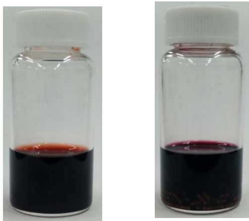
図 3 LCO プレカーサー水溶液 (左) と LCO プレカーサー溶液の外観写真 (右)
