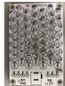
図 4 製作した 7 直列 7 並列の LED 基板
