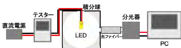
図 2 ウォールプラグ効率測定の実験系。
