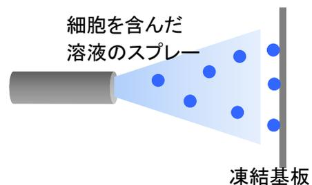
図1 開発した急速凍結の模式図
