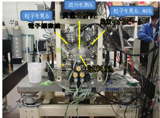
図3 他の分析法と比較した凍結SIMS(二次イオン質量分析法)の応用先と装置の写真
