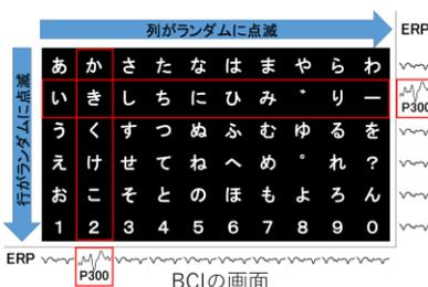
BCIの画面には文字盤が表示されている。BCIは文字盤の一行または一列を無作為に点滅させ、ユーザーは画面の特定の文字に注意を向ける。注意が向いている文字が点滅すると脳波の振幅が増大し、注意が向いていない文字が点滅すると振幅は変わらない。行と列の交点の文字が意図した文字と推定される。
