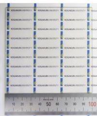
電圧を印加させて発熱ヒーターとして動作します。ガラスが母材であることから、無色透明で**耐候性が高い**です。
