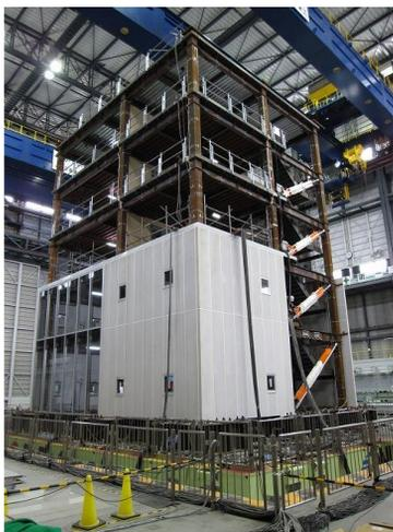
実大5層制振建物の震動台実験
