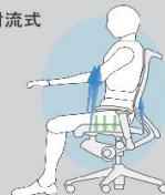
座面による吸気で熱籠りを解消 座面側面からは等温気流を吹出す
