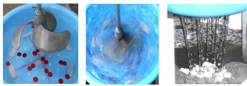
a) 古紙切削体の投入 b) 攪拌分離・積層状態 c) 溶液の排水状況
