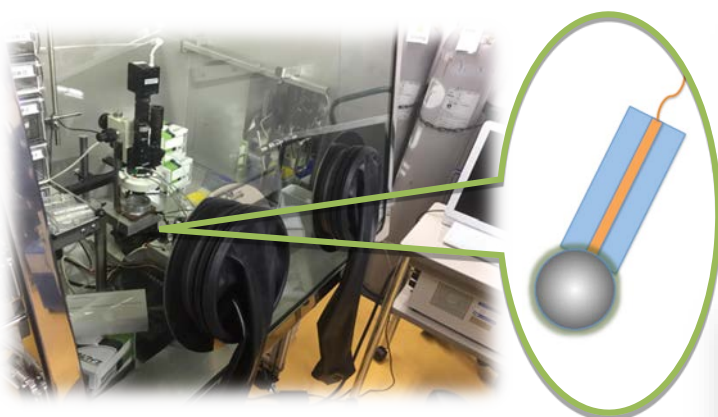
マイクロメーターサイズの電極・電解質粒子の電気化学測定システム.
