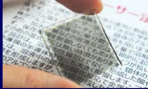
銅錯体溶液の塗布・低温熱処理で、ガラス基板によく密着した低抵抗な銅薄膜を形成しました。この溶液を用いると、ULSI用のトレンチ内部に隙間なく銅を埋入できます。
