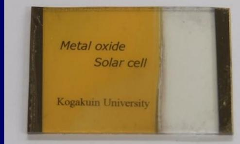
高いホール移動度をもち、かつ純粋なp型 $\text{Cu}_2\text{O}$ 薄膜を化学的に初めて形成しました。その膜を利用して、薄膜トランジスタやp-n接合型太陽電池を作製しています。
