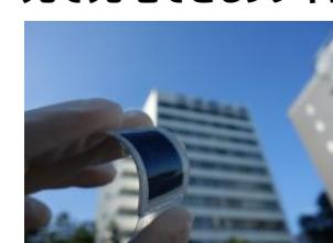
光充電型リチウムイオン電池を改良し、軽量・フレキシブルなリチウムイオン電池を作製しました。
