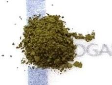
溶液条件で銅と酸化銅(I)粉末を選択的に形成可能です。機能性インクへの応用が期待されます。
