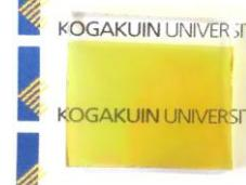
条件の最適化でガラス基板に密着した酸化銅(I)も形成可能。デバイスへの応用を検討中。
