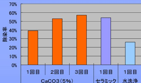
ソフトブラスト法による除染実証試験結果
