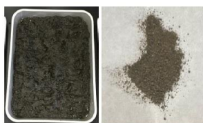
消化汚泥の処理 (水洗、乾燥、粉末化)
