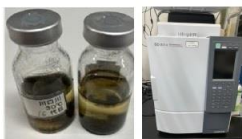
消化汚泥発酵試験 GC-TCDによる発酵ガス分析
